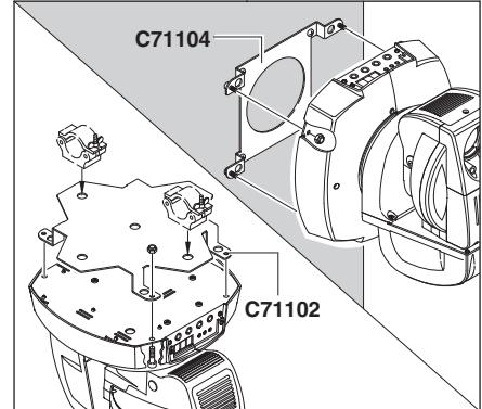
Il proiettore può essere installato a pavimento in appoggio sugli appositi gommini, su truss, a soffitto o a parete. Per l'installazione a parete o a soffitto, utilizzare 4 viti Ø 5 mm complete di dado e rondella elastica. Per l'installazione su truss è inoltre disponibile a richiesta la piastra cod. C71102 mentre per l'installazione a parete è disponibile la piastra cod. C71104.
