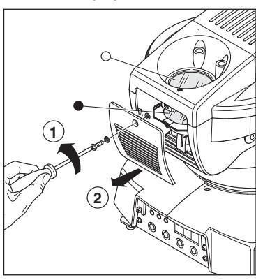
Per rimuovere lo sporco dal vetro di protezione della lampada (●) e dai filtri colore (○) usare un panno morbido inumidito di un qualsiasi liquido detergente per la pulizia del vetro. Non usare solventi o alcool.
