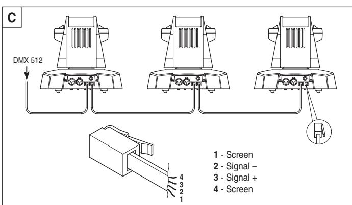
Fig. A-B - Utilizzare un cavo conforme alle specifiche EIA RS-485: bipolare intrecciato, schermato,  $120\Omega$  di impedenza caratteristica, 22-24 AWG, bassa capacità. Le terminazioni devono essere effettuate con connettori maschio/femmina tipo XLR a 3 pin. È necessario inserire sull'ultimo apparecchio uno spinotto terminale con una resistenza da  $120\Omega$  (minimo  $1/4$  W) tra i terminali 2 e 3 (Fig. A) oppure tra i terminali D+ e D- (Fig. B).
